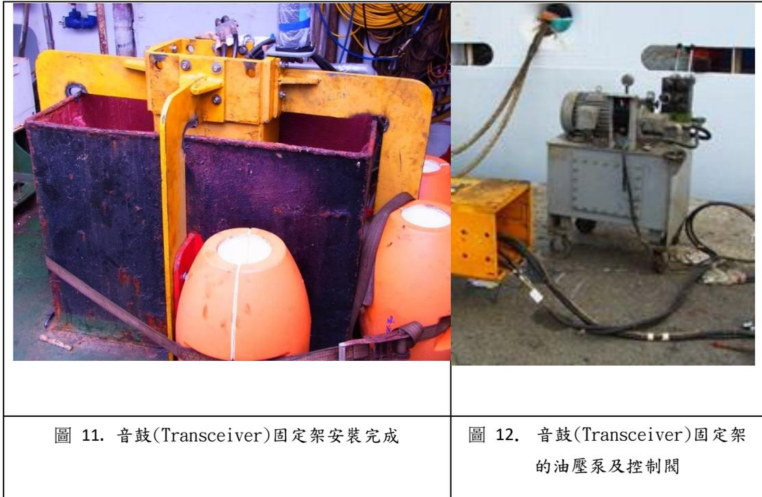
音鼓的伸縮固定架可伸縮約 2 公尺(如圖 8)。當開始定位作業時，要先操作油壓泵控制閥將伸縮固定架伸出，讓音鼓(Transceiver)伸出超過船底，如此聲波訊號的傳遞才不會受到船體遮蔽影響；當船隻未作業航行時，一定要收回音鼓的伸縮固定架，避免船隻高速行駛下讓音鼓或船體受損。
