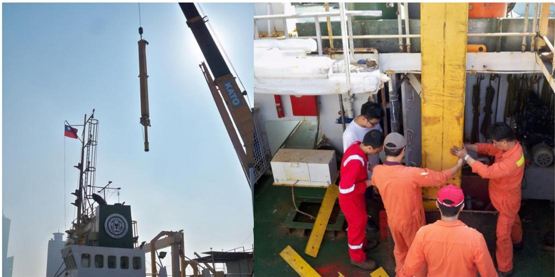
圖 10. 45 噸吊車將音鼓(Transceiver)固定架吊至海研一號月池
