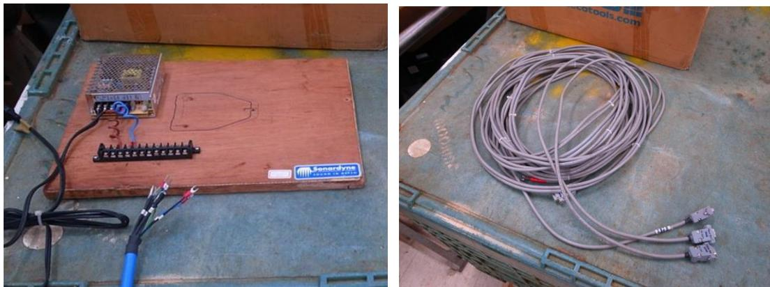
圖 14. VRU 的電源供應器及資料傳輸線
