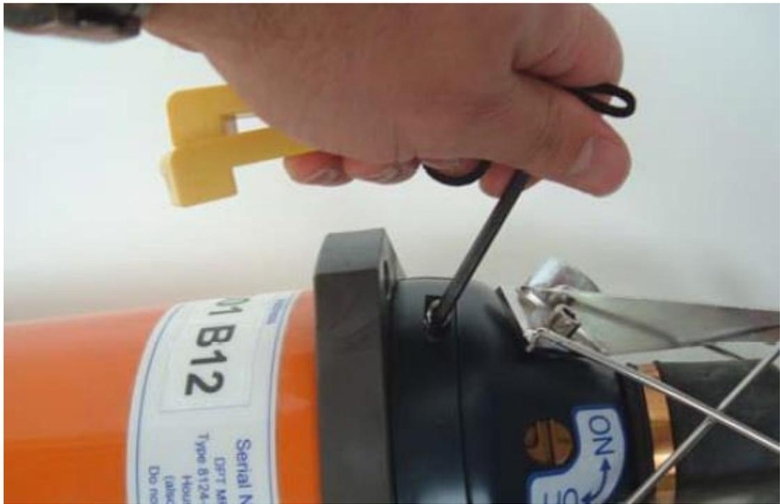
圖 40. 使用六角板手卸下螺絲
