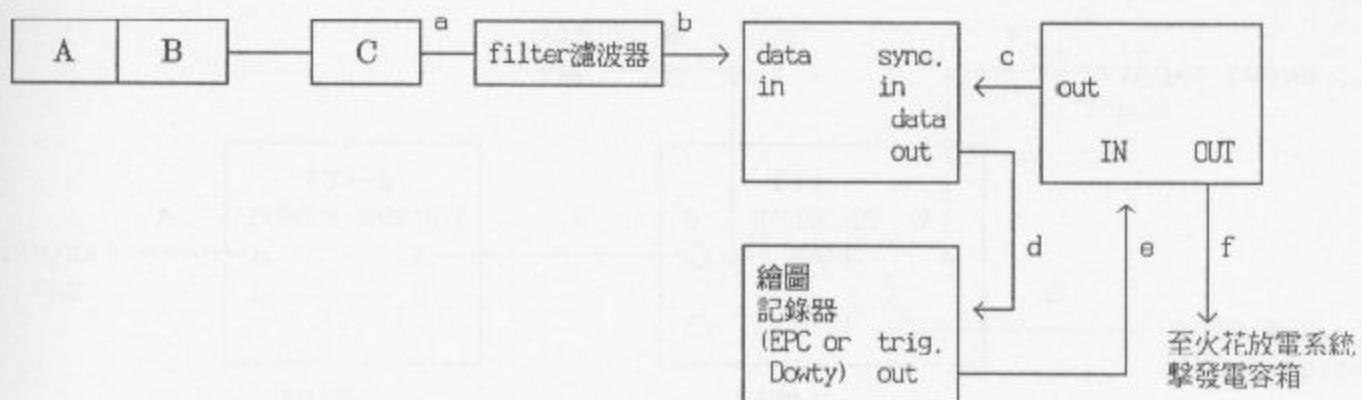
case 2: 聲波收訊電纜，濾波器，SE881聲納信號處理系統，繪圖記錄器之組合。
