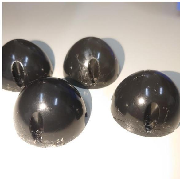
圖六、螺旋槳後塑膠蓋破損以及使用強力膠修補後照片。
