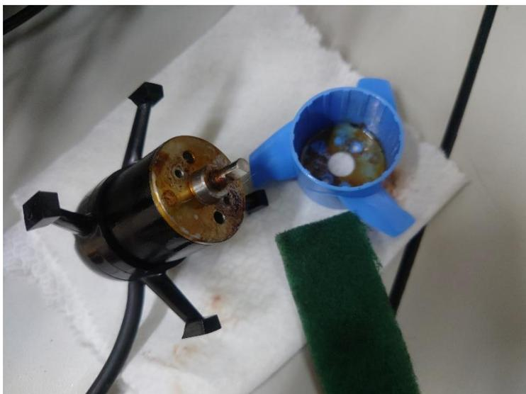
圖五、生鏽的螺旋槳馬達面。
