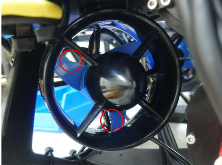
圖二、三號螺旋槳葉片受損照片，可見紅圈處有明顯缺刻。
