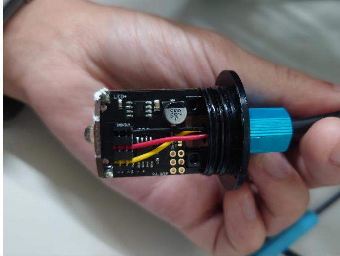
圖二、前蓋分離後可見燈光內部電路板。
