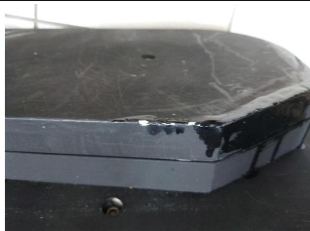
C. 為拆裝 oil-filled junction box 時造成的磨損。
