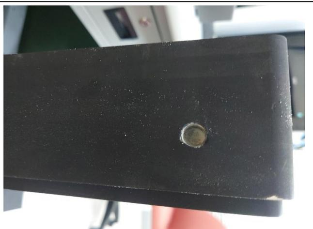
F. 用於固定浮材的預埋螺母在螺絲反覆的拆卸後鬆脫，導致無法鎖上螺絲，固定浮材。
