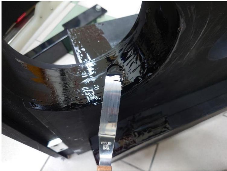
圖四、使用抹刀塗抹 AB 膠。
