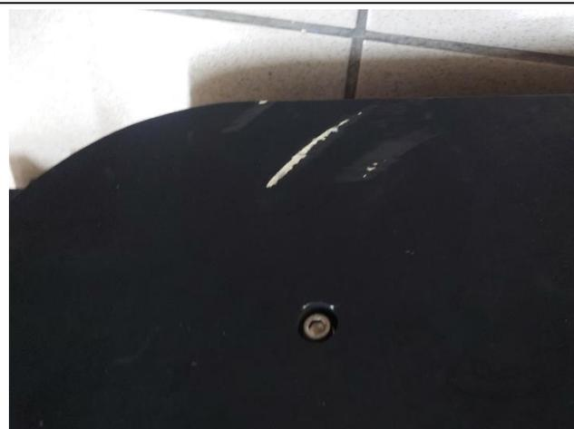
E. Pan & Tilt unit 在最低位置左右移動造成的磨損，考慮在 Pan & Tilt unit 的邊角裝上保護套以減緩磨損。
