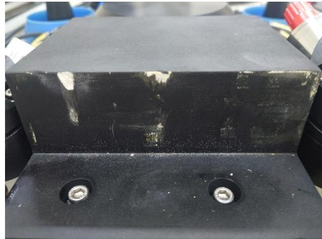
A. 位在 ROV 本體上方的浮材，拆裝黃色浮材時造成的磨損。
