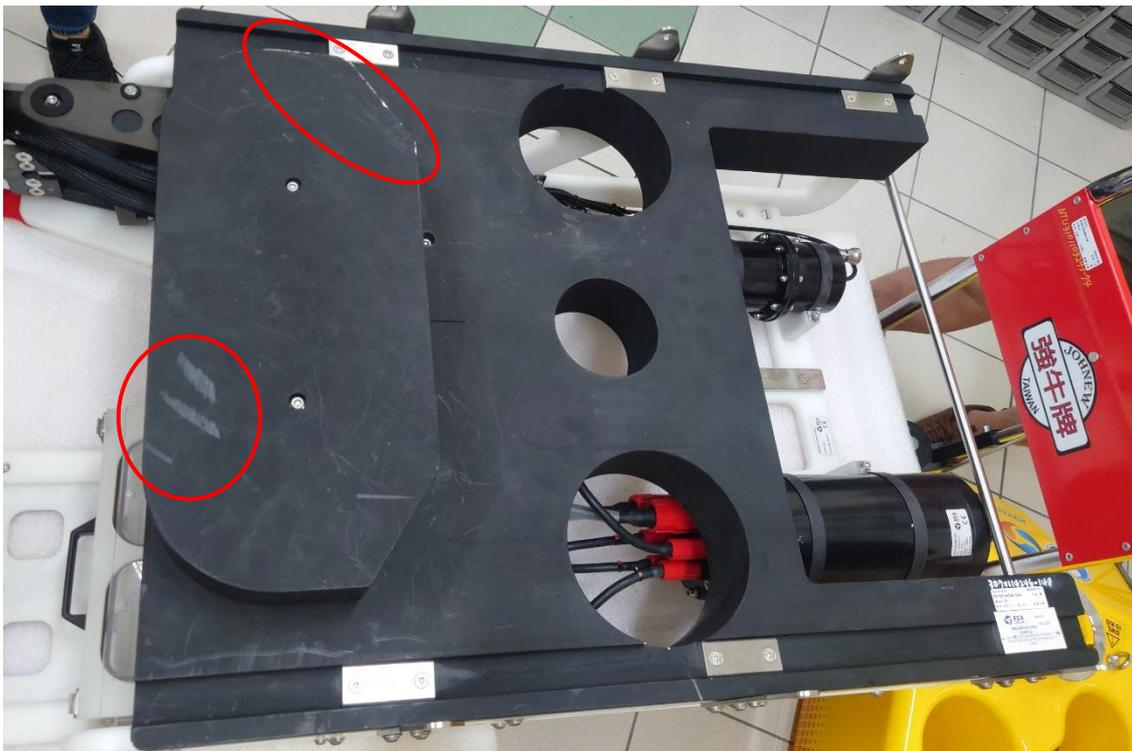
圖一、取下機械手臂的 skid 可見浮材上有數處明顯傷痕（紅圈處）
