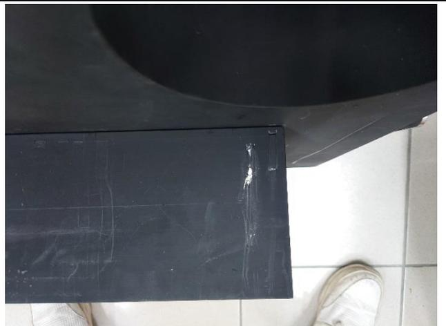
D. 安裝機械手臂浮材時被下方的配線刮出來的損傷。
