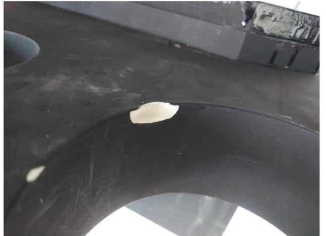
B. 可能為拆裝 oil-filled junction box 時造成的破損。
