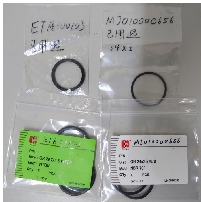
圖七、原安裝(上)以及更新後(下)的 O-ring。
