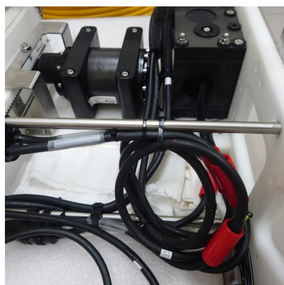
圖九、浮材安裝方向以及線材固定照片。
